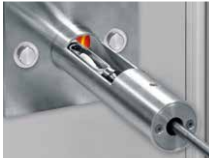
Introducción manual de la muestra en el horno con el mecanismo de carga
