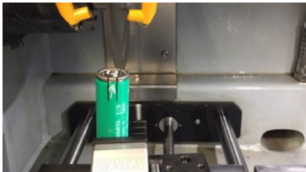
Seccionamiento de una LIB completa con la tronzadora QATM
