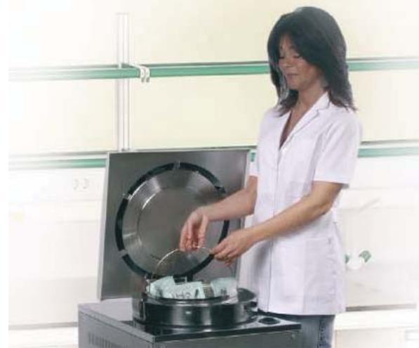
Cualquier error de funcionamiento o ejecución se traduce en un mensaje en el panel de mandos y un aviso acústico desconectando automáticamente el generador de vapor.
